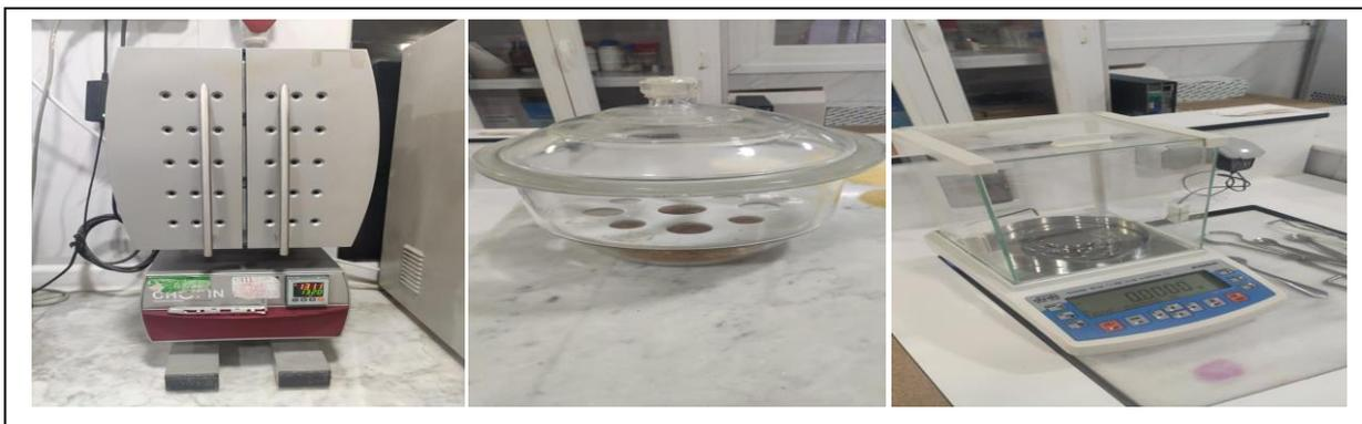
**Figure (09) :** Matériels utilisées pour l'analyse de la teneur en eau ou l'humidité du couscous [étuve ; dessiccateur ; Balance analytique]
