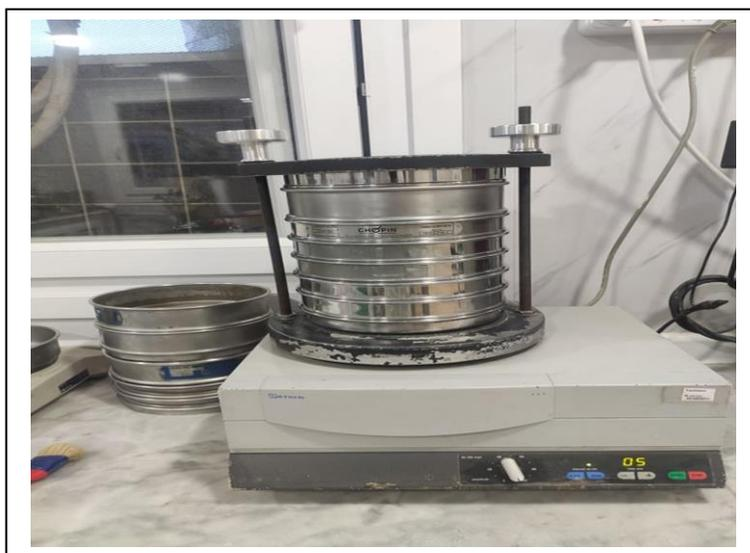
**Figure (11) :** Tamiseur utilisé pour l'analyse de granulométrie du couscous
