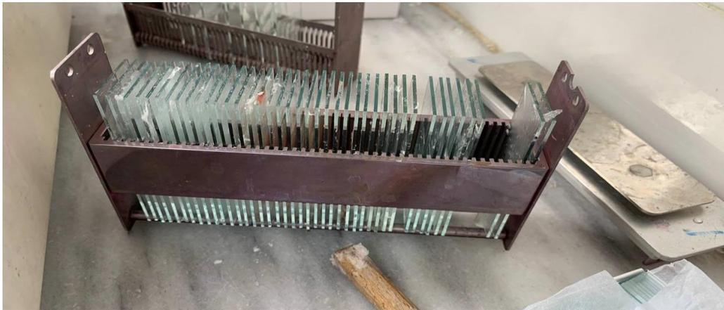
**Figure 9 :** Coupes fines disposées sur des lames porte-objet obtenues après microtomie.
