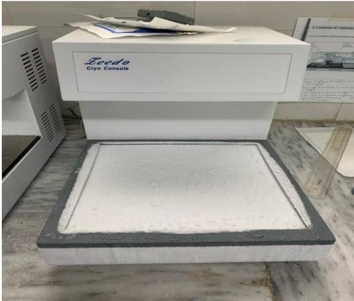
Appareil d'inclusion : plaque réfrigérée
