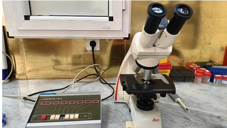
*Figure 15 : Microscope photonique et un compteur manuel.*
