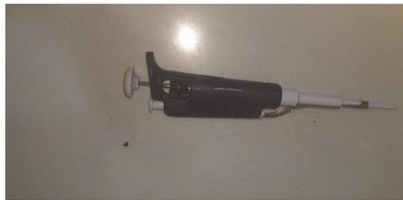
**Figure 21:** Micropipette.
