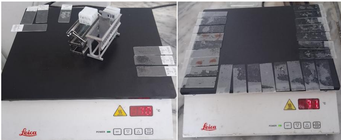
Figure 05 : Fixation des blocs dans le Microtome, récupération et séchage des lames dans plaque chauffante .
