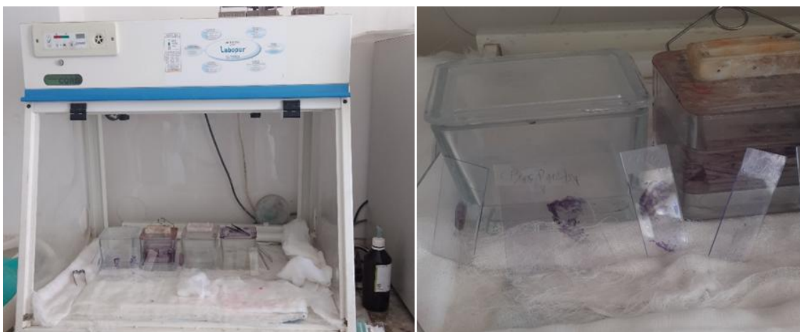
Figure 07 : Application de la résine synthétique sur les lamelle et montage des lames colores
