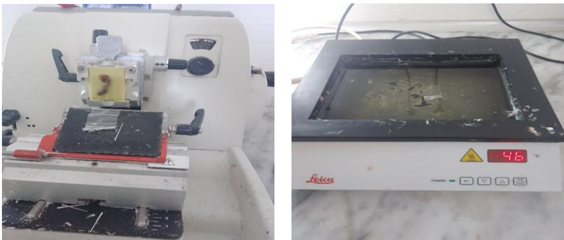
Figure 04 : Prelevement et fixation des echantillons dans des moules recouvertes par la partie inferieure des cassettes et congelation.
