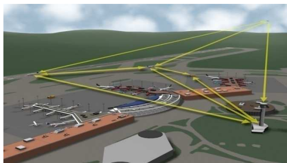
Figure III.1. Réseau d'échange d'informations ADS-B.
