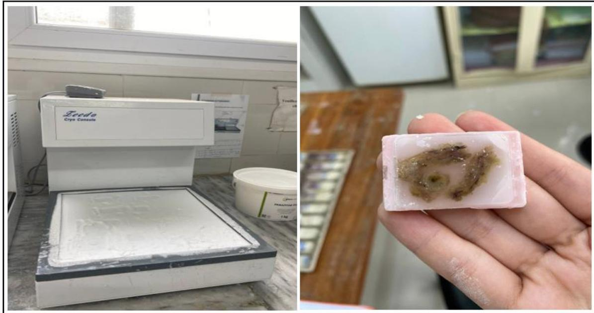
Figure 23. Appareil de refroidissement (à gauche), bloc de paraffine (à droite)
