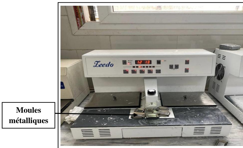
**Figure 22.** Appareil d'enrobage (Leedo ES300, Bio Hisure, Chine)
