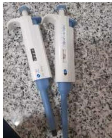
**Figure 6 : Micropipette**
