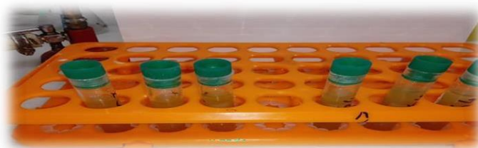
Fig. 25: Remplissage du tube avec 2/3 de dilution et 1/3 éther.
