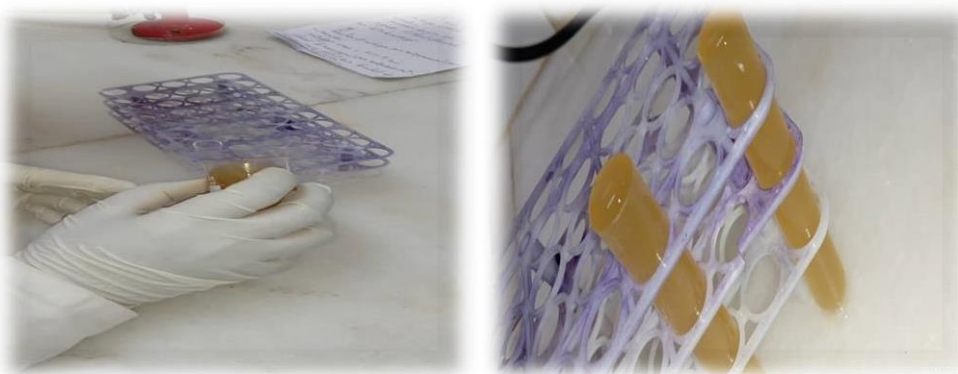
Fig. 21 : Version de la suspension et obtention d'un ménisque.
