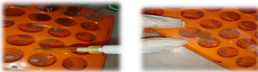
Fig. 29: Préparation de la lame pour l'observation.
