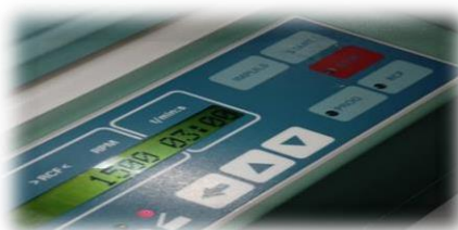
Fig. 26 : Centrifugation de solution à 1500 tour /min pendant 3min.
