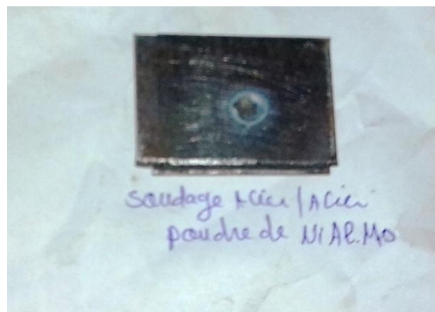
Figure IV 2: soudage acier /acier / poudre NiAlMo .
