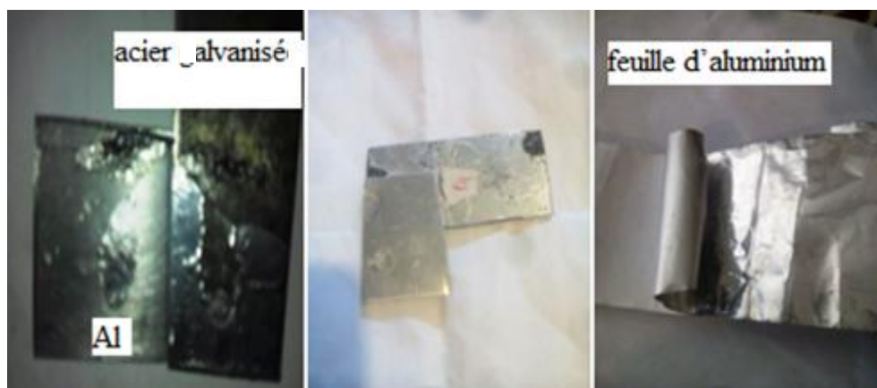
Figure IV 21: Soudage par point acier galvanisé/feuille d'aluminium/aluminium.
