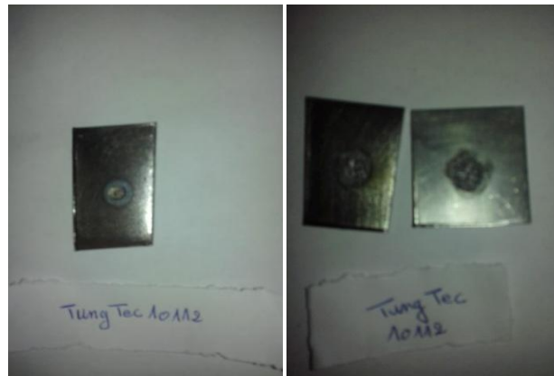
Figure IV 10 : soudage acier /aluminium par poudre de Tungtec.
