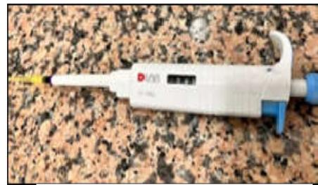
Figure27: pipette réglable avec embout
