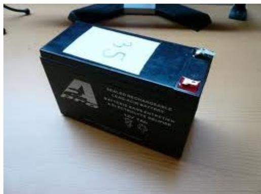
**Figure 2. 2.** Batterie utilisée 12v 7A
