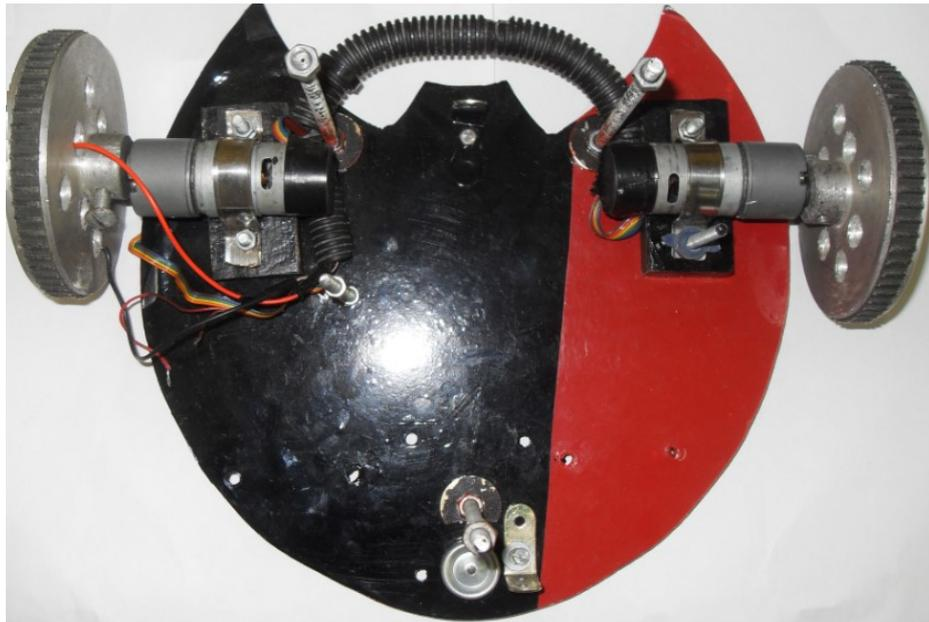
**Figure 2. 1.** Base mécanique du robot aspirateur
