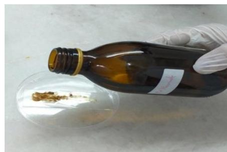
2. Recouvrir avec le méthanol et permettre de sécher 5 minutes.
