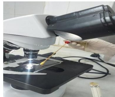
4. Mettre une goutte de suspension sur une lame.
