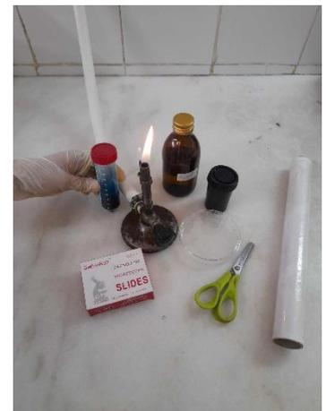
Matériel et réactif utilisé pour la technique de kato katz
