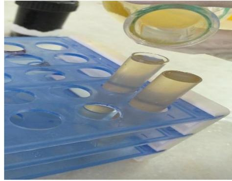
4. Verser le mélange dans un tube à essai jusqu'au obtenir un ménisque convexe.
