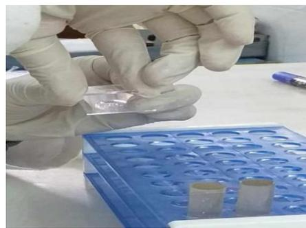
6. Déposer la lamelle sur une lame porte-objets.
