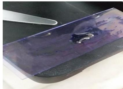
8. Mettre l'huile à immersion et examiner au microscope G×1000.
