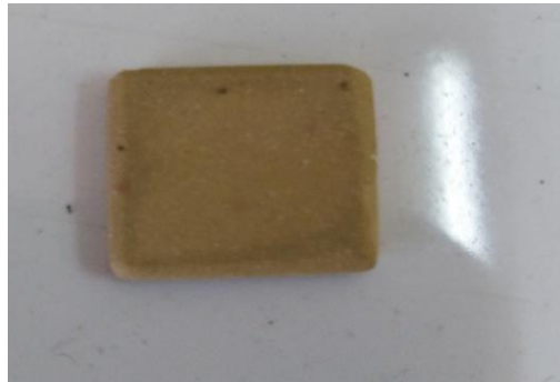
Figure III.6: Echantillon de Ti 2 AlN après le traitement.
