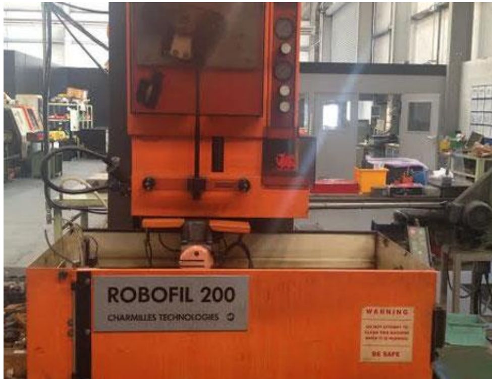
Figure III.2 : Machine de découpage par électroérosion ROBOFIL 200.
