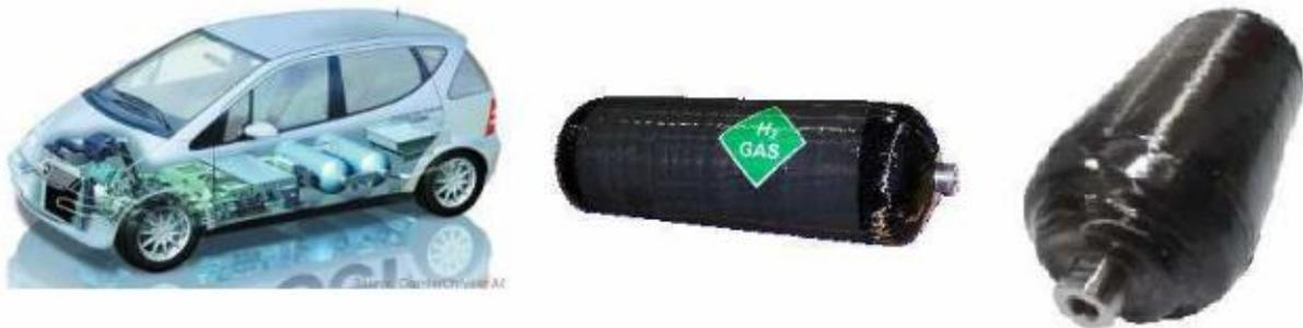
Figure (2.8) : réservoirs bobinés type IV
