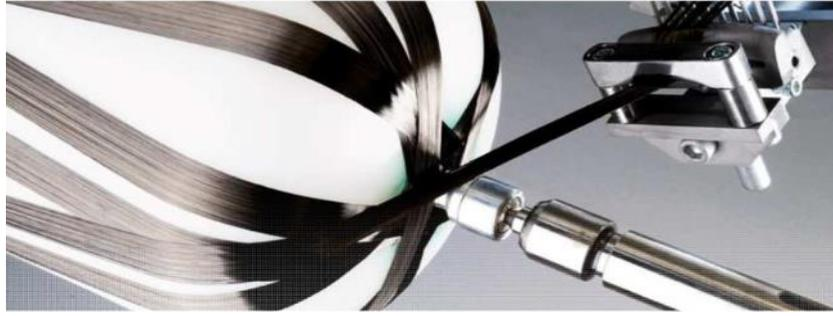
Figure (3.2) : Procédé de fabrication des réservoirs composites par enroulement filamentaire
