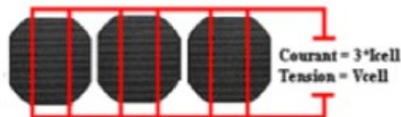
*Figure 1. 6.* Cellules connectées en parallèle avec leur caractéristique courant-tension.
