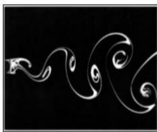
Figure I.11. Visibilité du cylindre fixe avec  $Re = 140$  [56].
