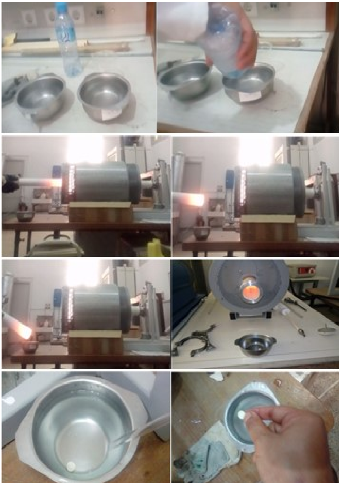
Figure II.9. Les différentes étapes de refroidissement des pastilles de \text{LuAlO}_3 , \text{Gd}_3\text{Al}_5\text{O}_{12} , (\text{Gd}_{1-x}\text{Lu}_x)_3\text{Al}_5\text{O}_{12} avec x=0.2 et 0.3 élaborés par la méthode de trempe.
