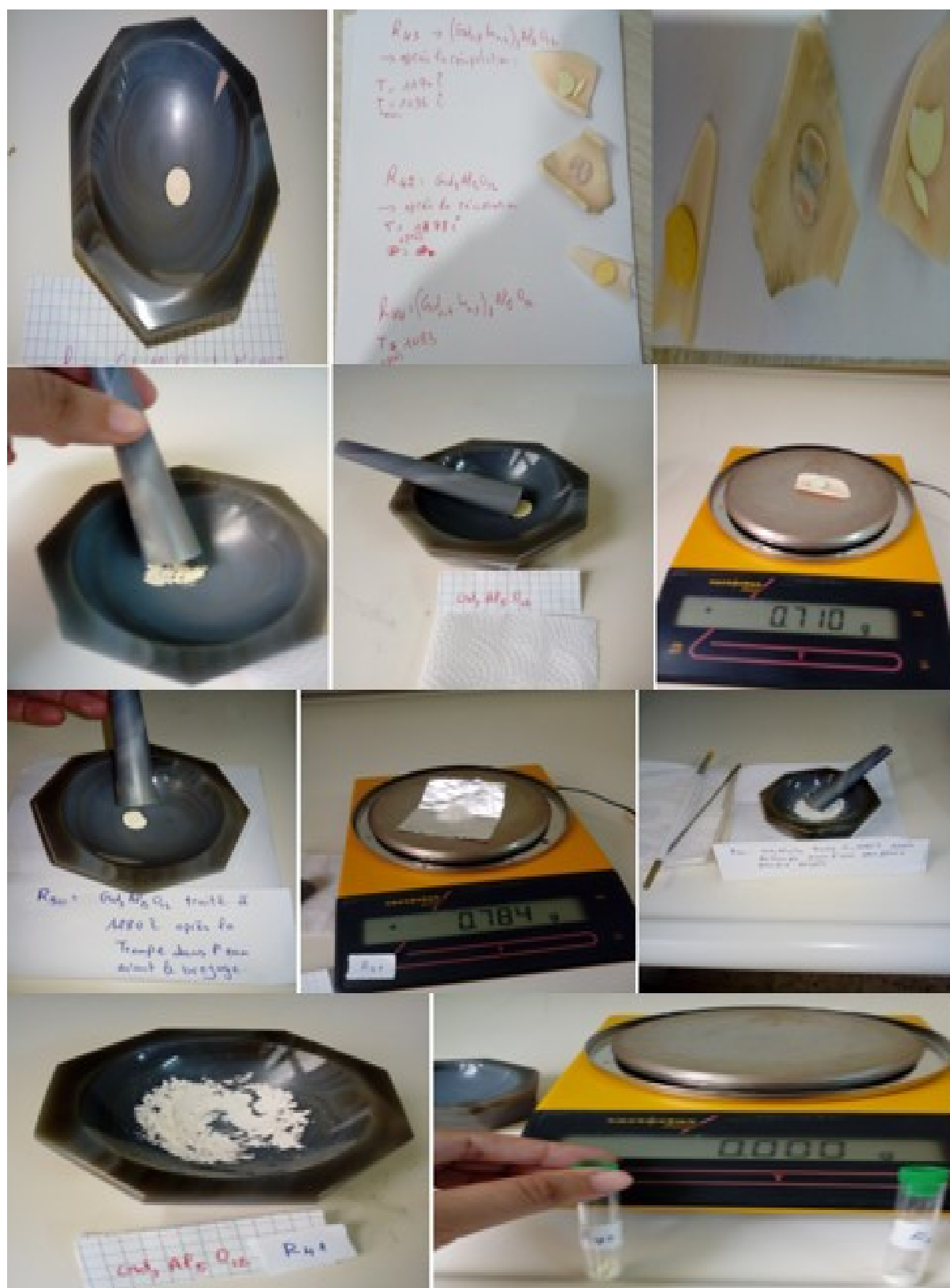
Figure II.10. Les pastilles après la trempe dans l'air et l'eau avant et après le broyage.
