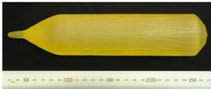
Figure I.10. Monocristal (\text{Gd}_{0.99}\text{Ce}_{0.02})_3(\text{Al}_{0.4}\text{Ga}_{0.6})_5\text{O}_{12} GGAG : \text{Ce}^{3+} élaboré par la méthode Czochralski [31].
