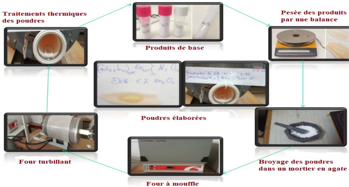
Figure II.2. Différentes étapes de synthèse par la méthode réaction à l'état solide.
