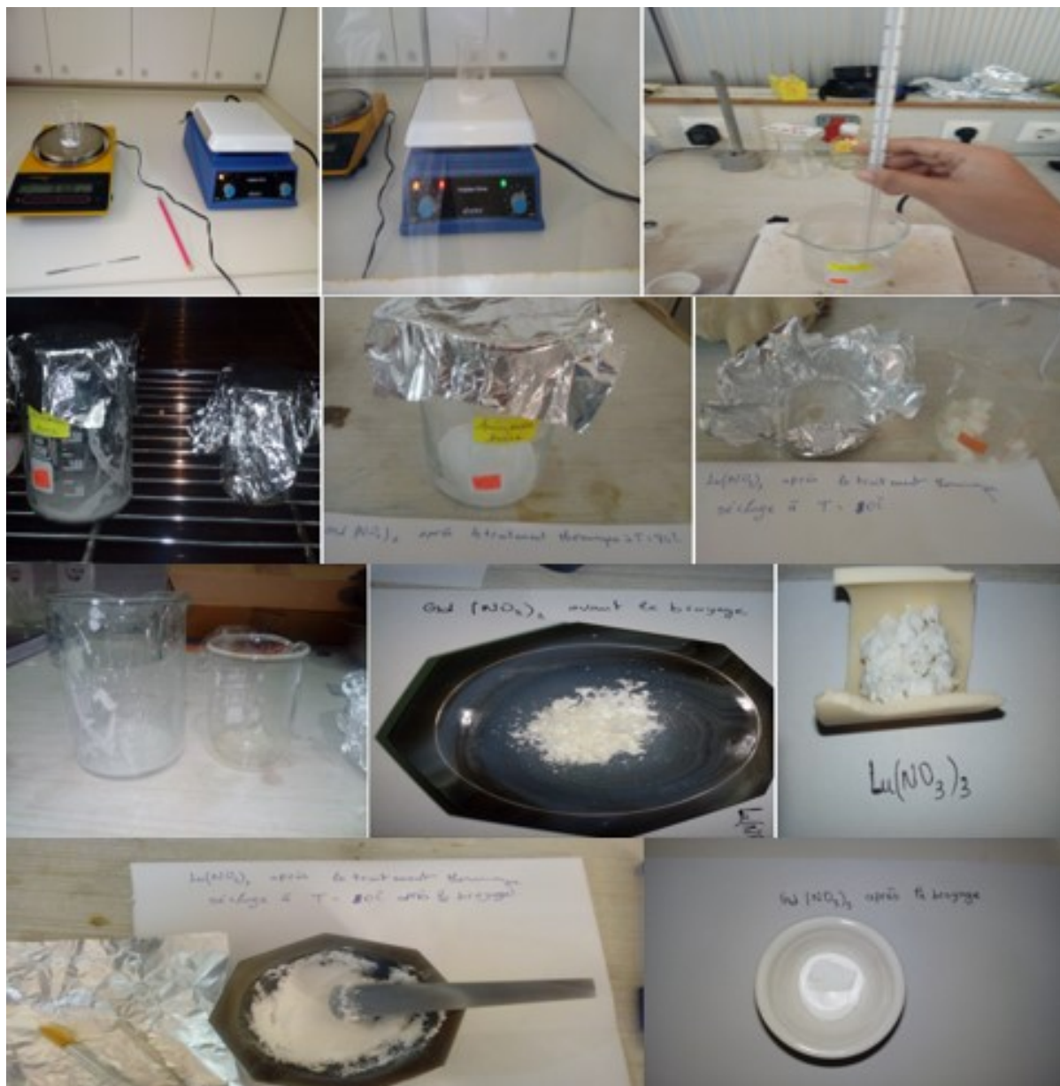
Figure II.11. Les différentes étapes de préparation de Gd(NO_3)_3 et Lu(NO_3)_3 .
