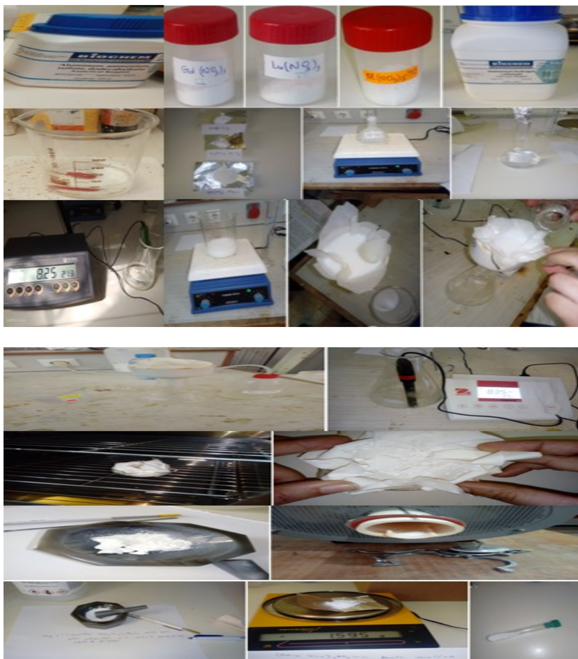
Figure II.16. Les différentes étapes de synthèse des grenats cubiques (\text{Gd}_{0.7}\text{Lu}_{0.3})_3\text{Al}_5\text{O}_{12} élaborés par la méthode co précipitation.
