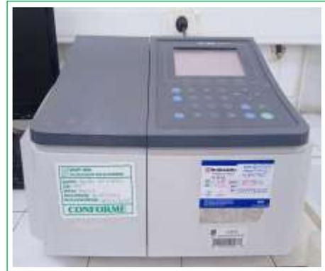
**Figure 40 : Spectromètre UV-visible**
