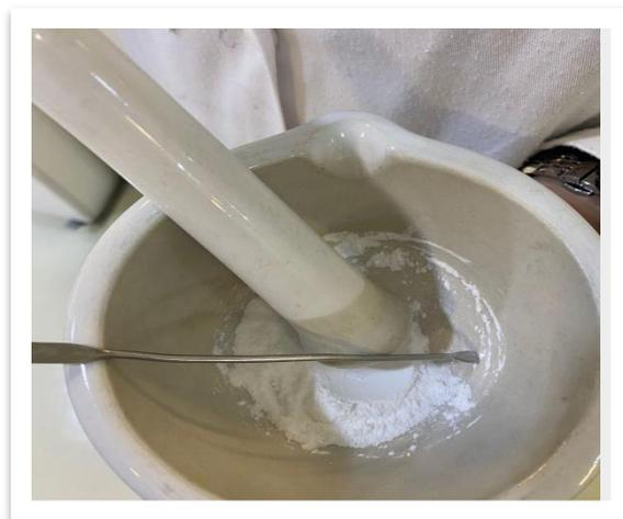
**Figure 4:** Broyage de 20 Cp de metformine chlorhydrate
