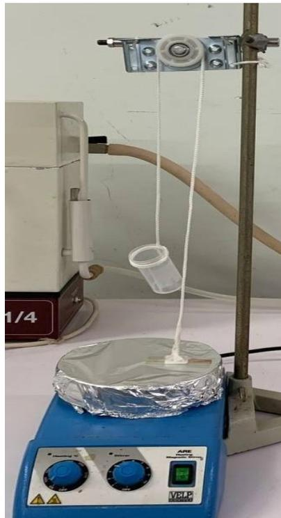
**Figure 2.8 :** Système mis en place pour les mesures des forces de bio-adhésion.
