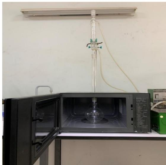
**Figure 2.4** : Photographie de l'installation d'extraction par micro-onde (Laboratoire pédagogique d'extraction, Bloc C, Ex-ISV, Université Blida 1).
