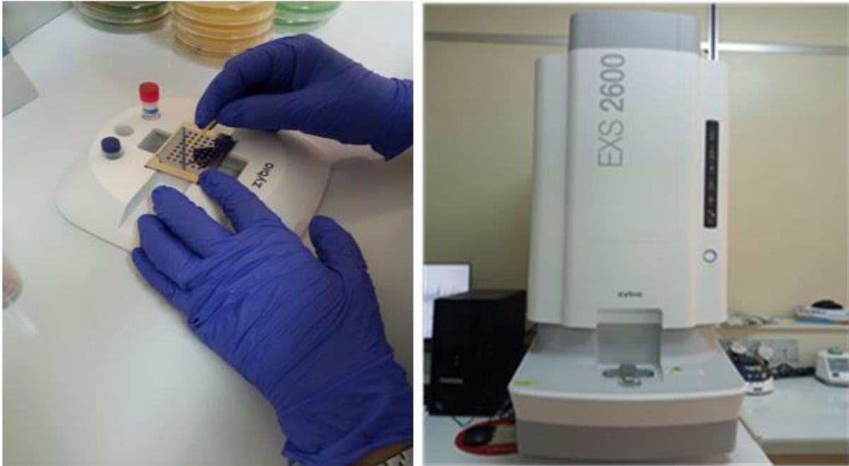
**Figure 11:**Appareil MALDI-TOF EXS2600 (photo prise à l'IPA. Département bactériologie médicale) (photo originale, 2024)
