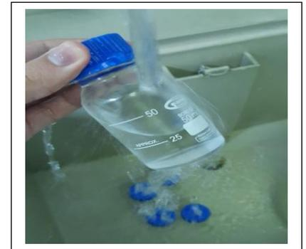
**Figure 36 :** choc thermique sous l'eau de robinet
