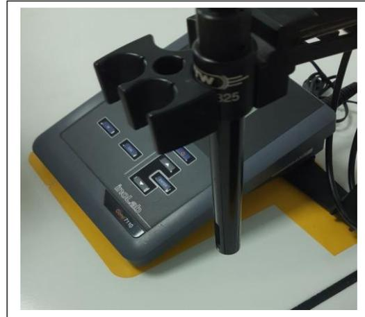
**Figure 8 :** sonde du conductimètre
