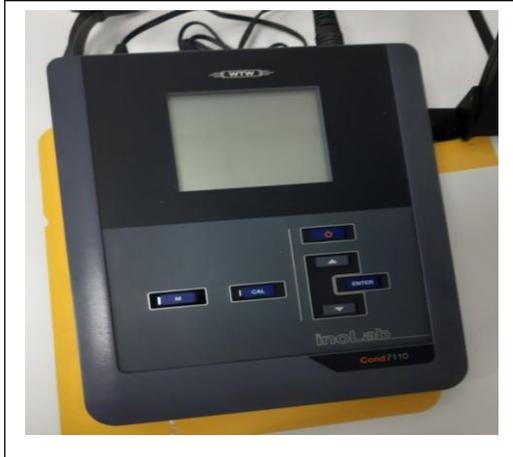
**Figure 7 :** conductimètre.
