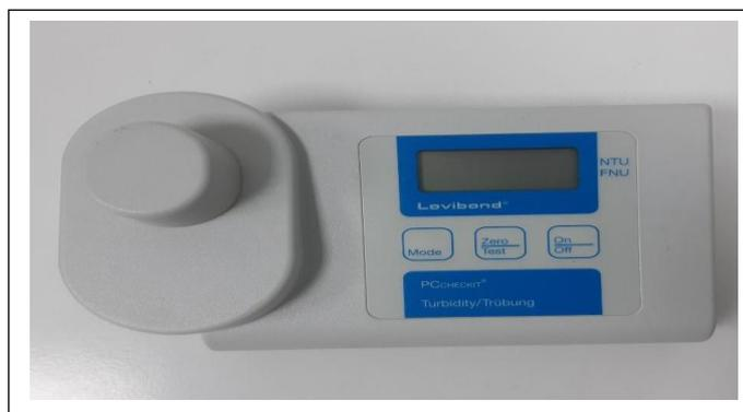
**Figure 9 :** turbidimètre
