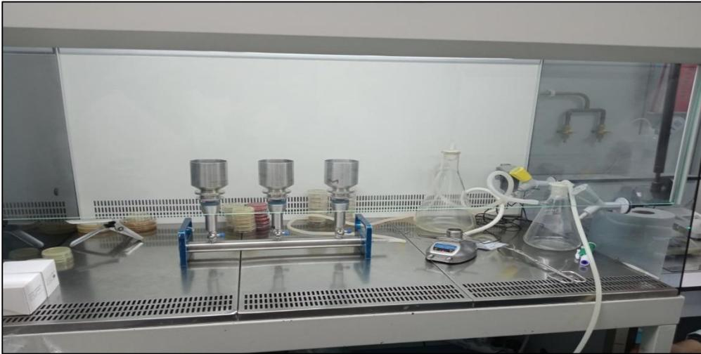
*Hotte à flux laminaire et la rampe de filtration à multi postes en inox*
