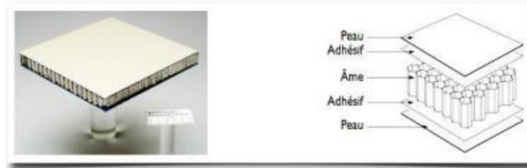
Figure (1.9) : Constitution d'un sandwich.
