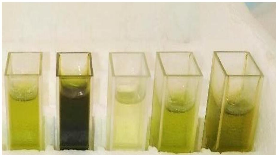
Figure 2.8. : Photographie des surnageants obtenus utilisés pour la détermination de la teneur en pigments (Chla et Chlb) (Photo originale).
