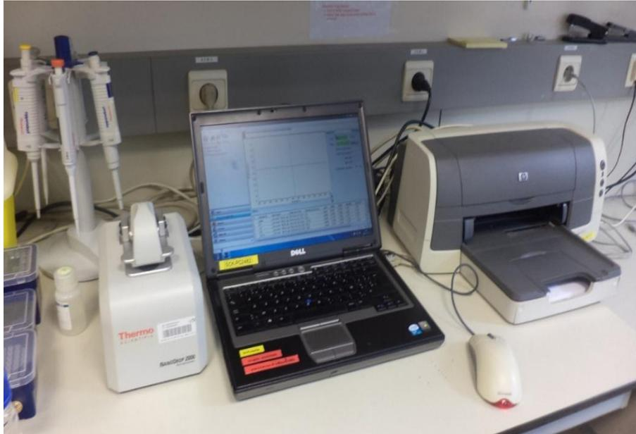
Figure 2.4 : Photographie du *NanoDrop* utilisé (Photo originale)
