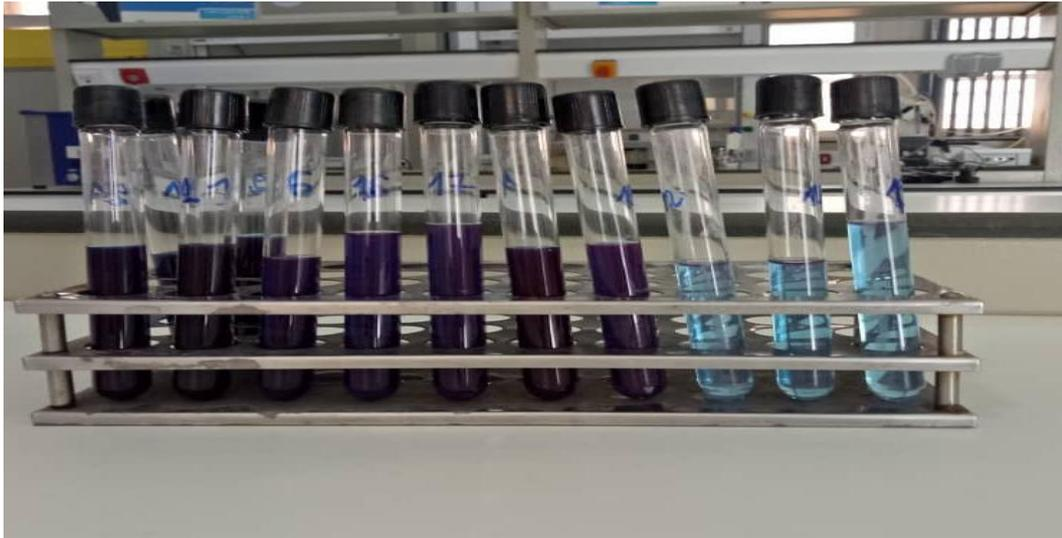
Figure 2.10 : Photographie de quelques surnageants récupérés après l'extraction de la C-PC et séparation de la biomasse (Photo originale)
