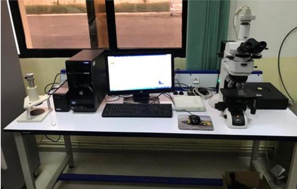
*Figure 2.3 Image du microscope optique NIKON ECLIPSE LV100NO*
