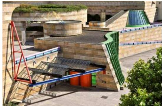
Figure 8.4 bâtiment avec une structure en béton armé et un revêtement non structurel. Bien que la structure joue un rôle essentiel dans la création de la forme globale complexe, elle n'est pas un élément significatif du vocabulaire visuel.
