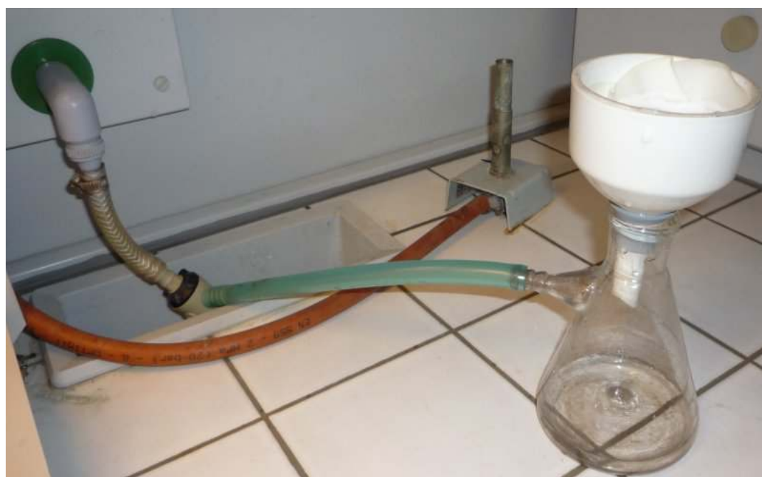
Figure ( annexe -2) : Dispositif de filtration sous vide
