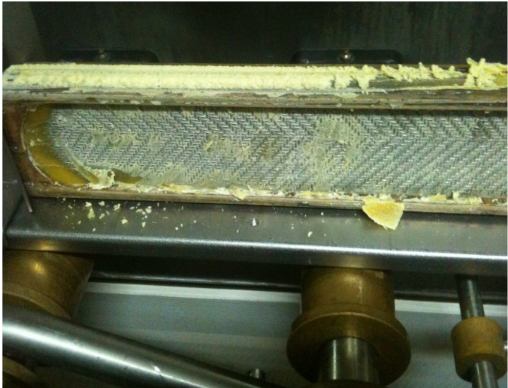
Figure II.8- Moule rectangulaire avant lavage sur le support
