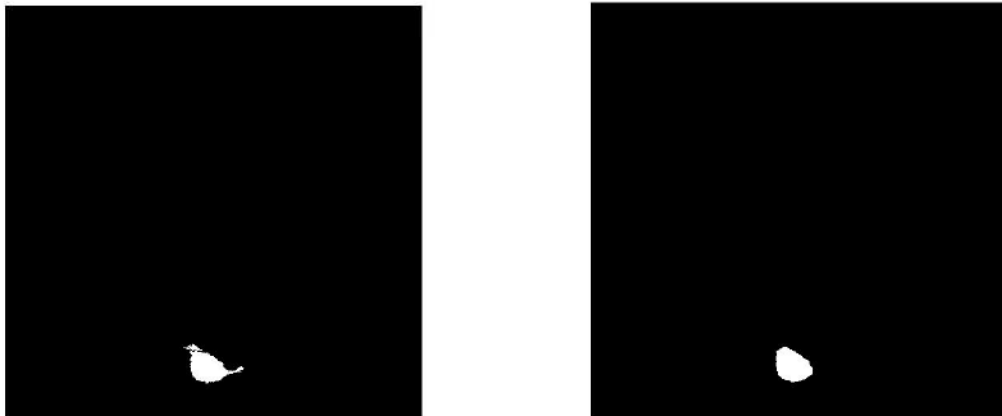
(a) Image segmentée [seuil=40] (b) Résultat du contour actif [10 itérations]
