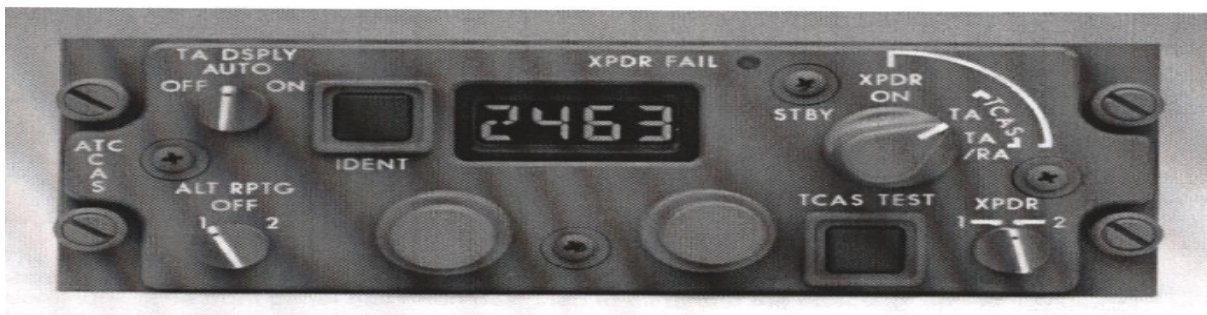
Figure .II.7 : Boite de commande TCAS /ATC
