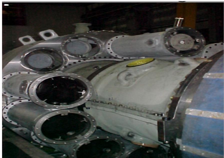
Figure (III.7) : Dispositif des chambres de combustion. Selon [4]
