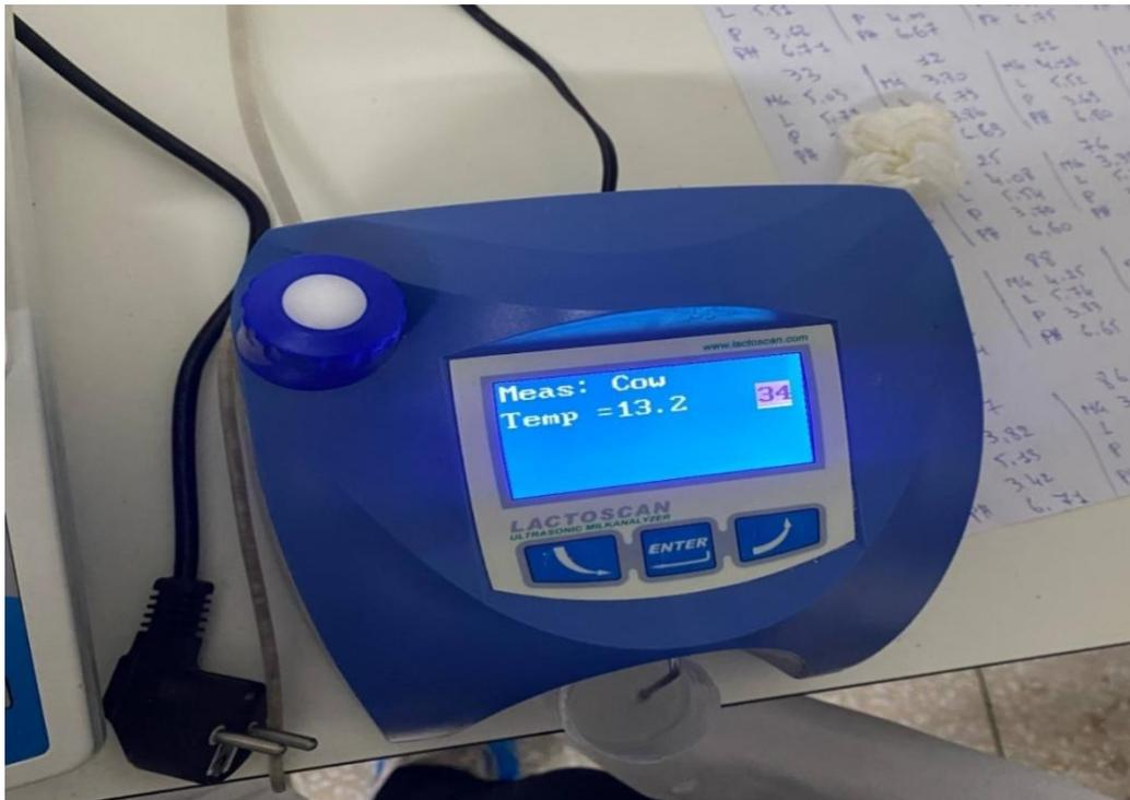
Figure 7: Analyse de la qualité du lait avec le Lactoscan SP1 en laboratoire.
