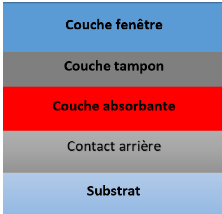
Figure I.10: Schéma représentatif d'une cellule solaire typique à base de CZTSSe.
