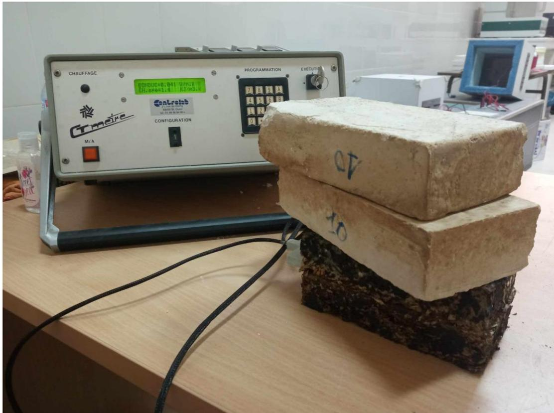
Figure XX: Mesure de la conductivité thermique.
