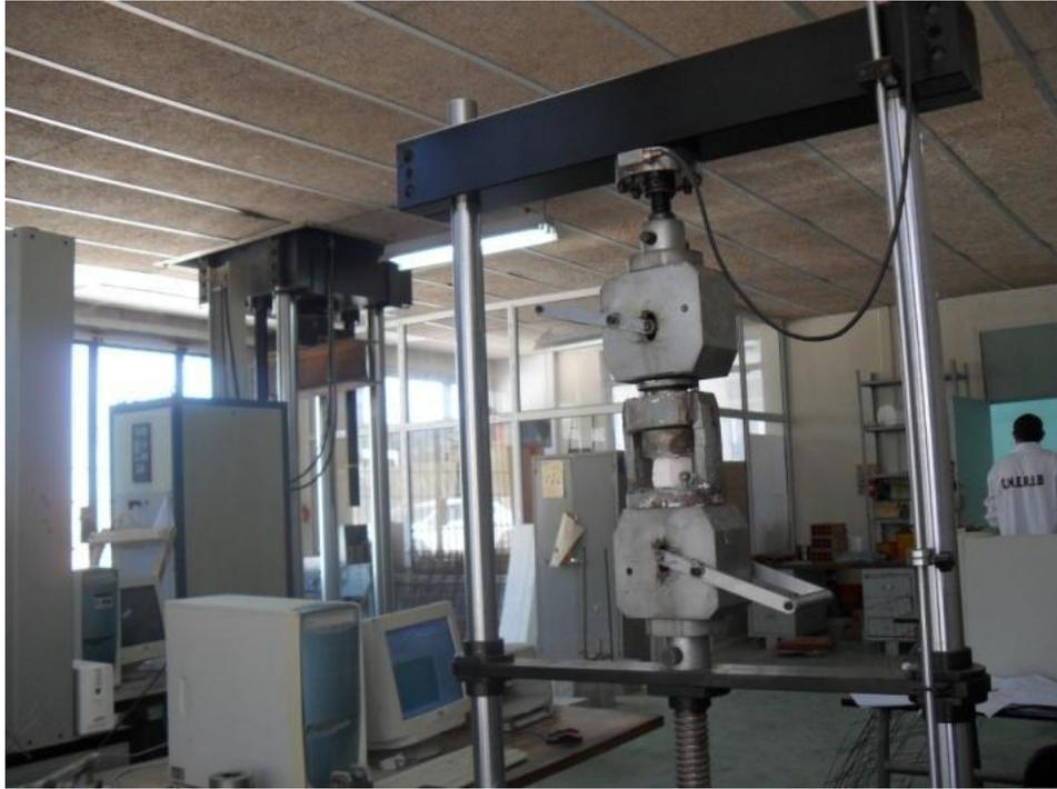
*Figure XVII: Machine d'essai de compression.*
