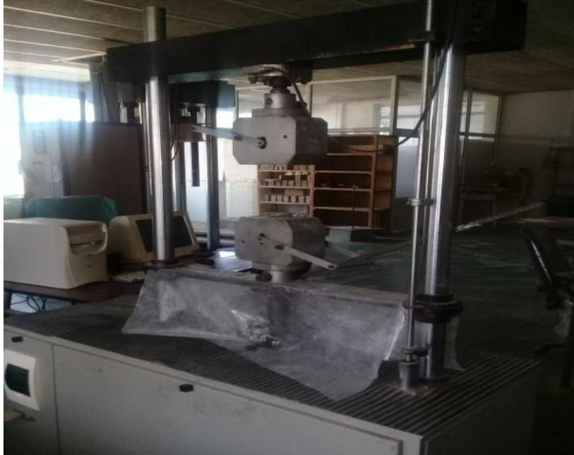
*Figure XV: Machine d'essai de flexion.*
