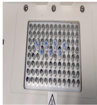
**Mise en place des micro tubes dans le bloc de thermocycleur**
