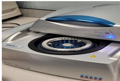
**Insérer les soigneusement dans bloc thermique de thermocycleur et lancer la programmation**
