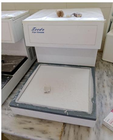
**Figure 5:** Plaque réfrigérante
