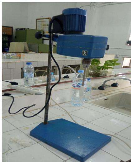
**Figure23 : Homogénéisateur**
