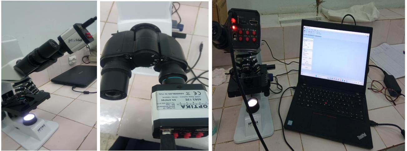
**Figure 13 :** Documentation des coupes histologiques à l'aide d'une caméra numérique connectée au microscope
