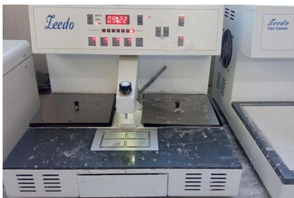
Figure 11: machine d'enrobage de tissus de paraffine
