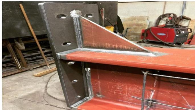
**Figure VII.1 :** Exemples des assemblages soudés.
