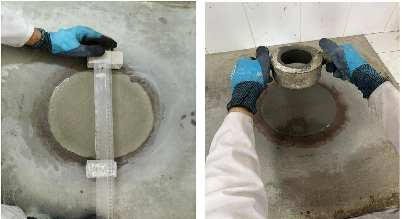
**Figure II.11** : Etallement au mini cône.
