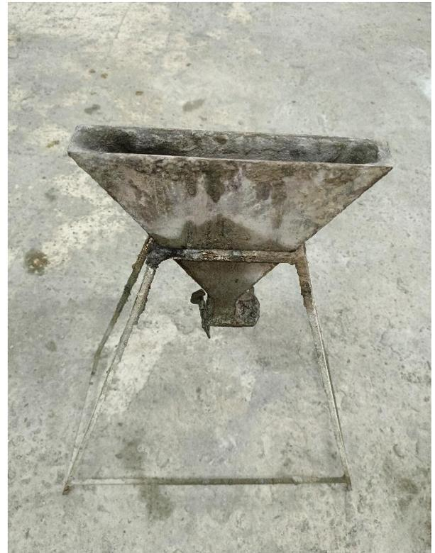
**Figure II.13 :** L'essai de V-Funnel.
