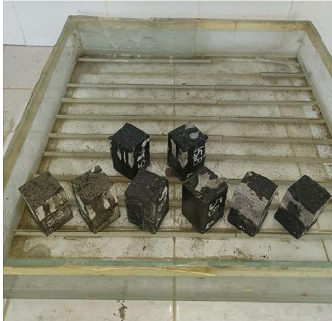
**Figure II.19** : Absorption capillaire
