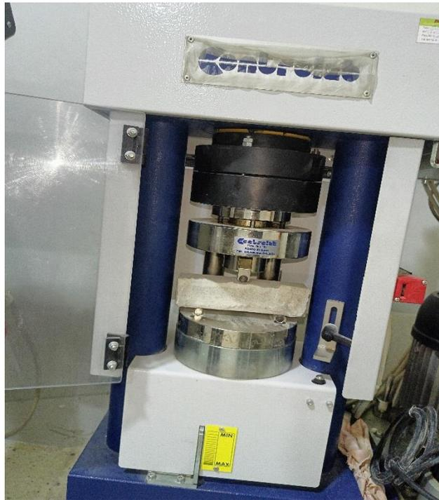
**Figure II.16** : Essai de résistance à la traction par flexion.
