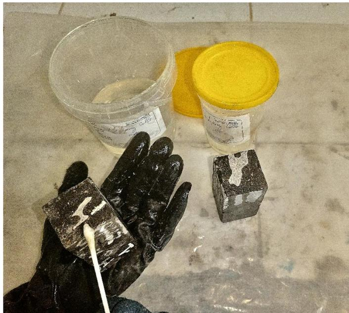
**Figure II.18** : Application de la résine sur la face inférieure de l'éprouvette.
