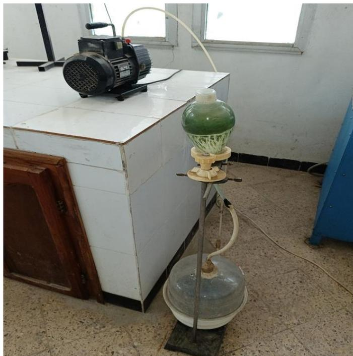
**Figure II.20** : L'essai de porosité accessible à l'eau.
