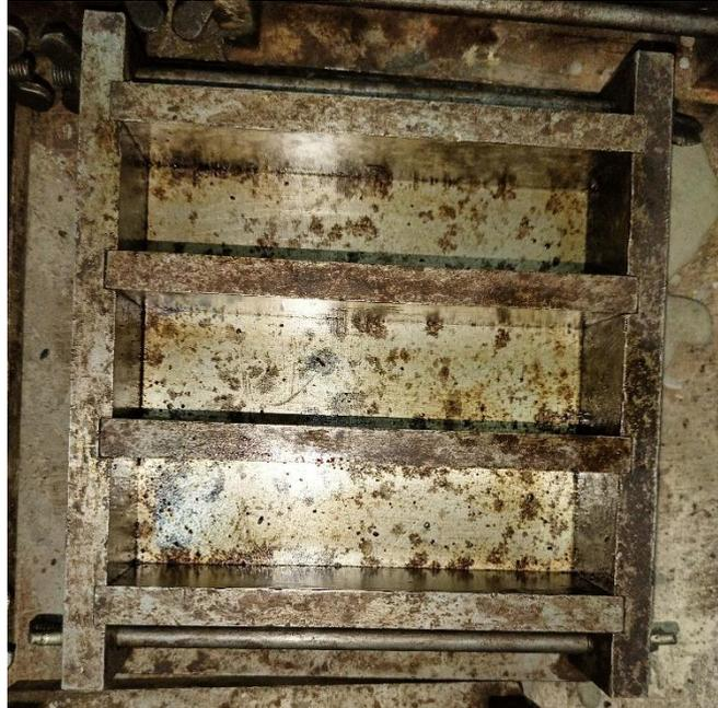
**Figure II.14** : Moule prismatique pour mortier.
