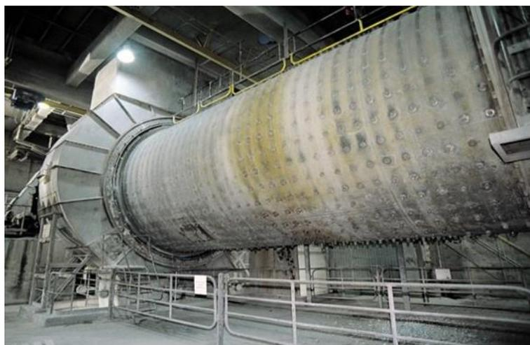
**Figure I.3 :** Broyeur à boulets de cimenterie [9].
