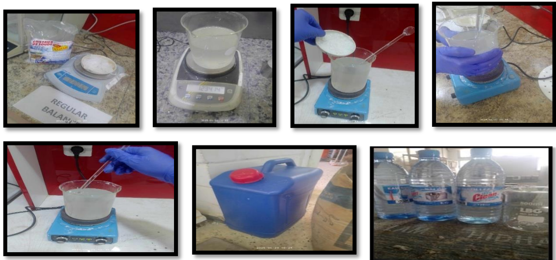
Figure II. 31: Préparation de la solution de silicate de sodium ajustée.
