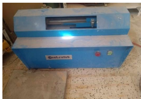
Figure II. 29: Agitation de l'éprouvette pour homogénéisation du mélange.
