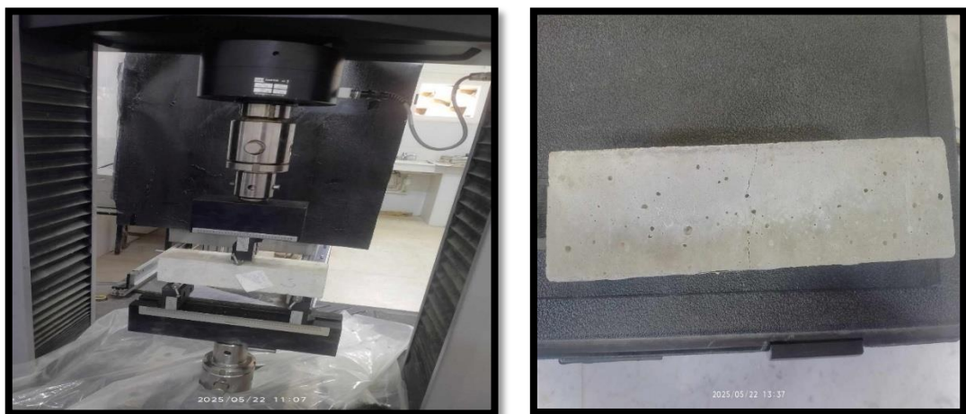
Figure III. 6: Illustration de l'essai de flexion et de la fissuration de l'éprouvette au milieu.
