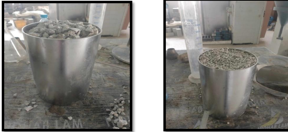
Figure II. 22: Gravier 8/15 et gravier 3/8 avec un volume de récipient constant de 5 litres.
