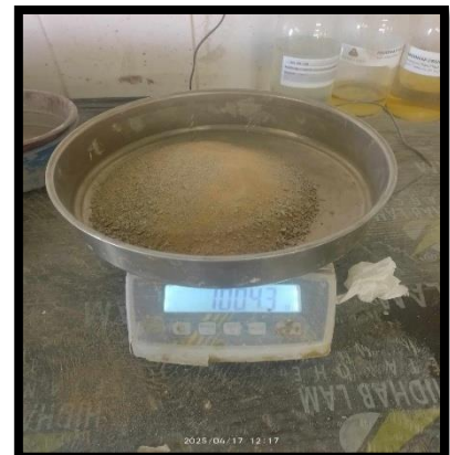
Figure II. 17: Préparation du mélange à partir des deux sables (sable de dune et sable de carrière).
