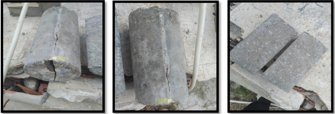
Figure III. 4: Illustration comparative de l'aspect des éprouvettes après essai de traction par fendage : à gauche, béton témoin ; à droite, béton fibré montrant une fissuration modifiée par la présence des fibres.
