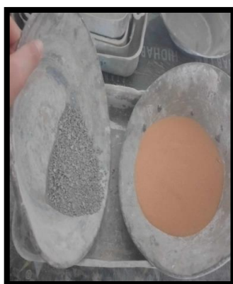
Figure II. 17: Préparation du mélange à partir des deux sables (sable de dune et sable de carrière).
