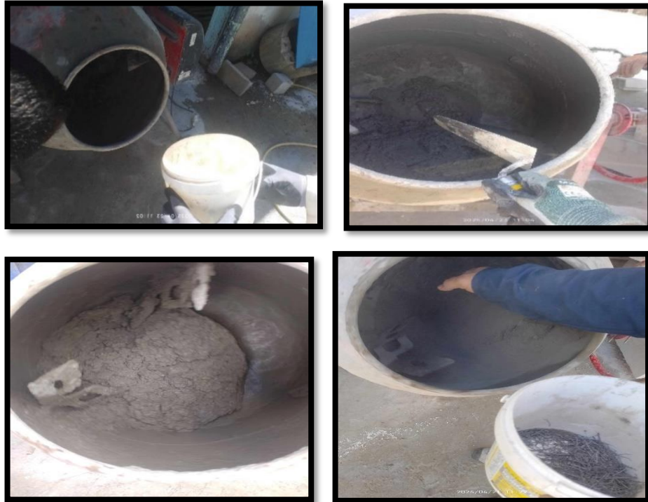
Figure II.31: Illustration du malaxage des différentes formulations : témoin, fibré, béton avec silicate de sodium, fibré avec silicate de sodium.
