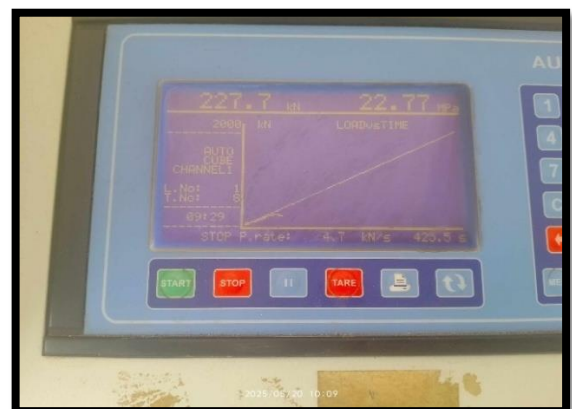
Figure III. 2: Résistance mécanique du béton témoin – Éprouvette cubique (à gauche) et cylindrique (à droite)
