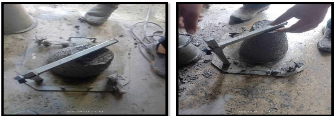
Figure III. 1: Illustration de l'affaissement des différentes formulations (4 formulations).
