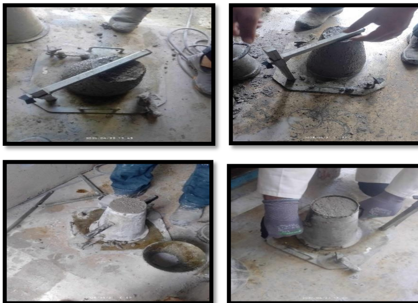
Figure II. 45: Illustration de l'affaissement des différentes formulations (4 formulations).
