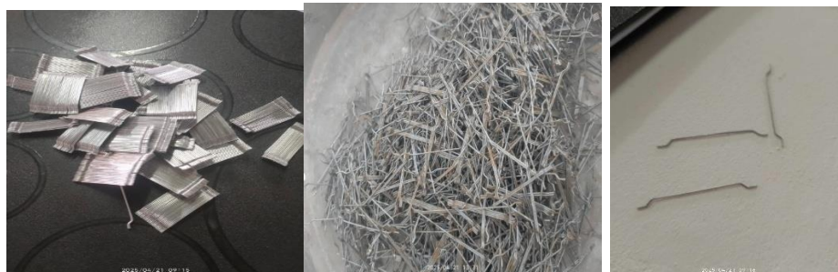
Figure II. 6: Illustration des fibres SikaFibre® Metal Chapes utilisées dans le béton.
