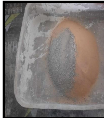
Figure II. 17: Préparation du mélange à partir des deux sables (sable de dune et sable de carrière).
