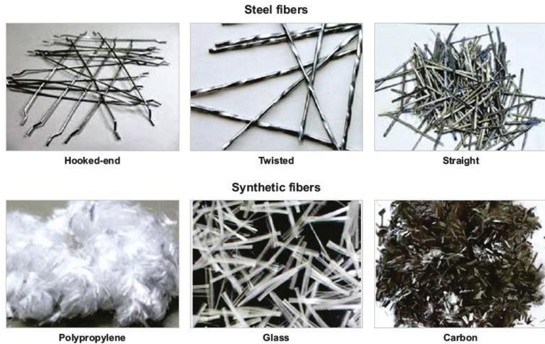
Figure I. 15: Illustration des différents types de fibres mentionnés précédemment [34] .
