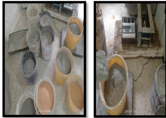
Figure II. 40: Pesage des quantités de sable, gravier et ciment.
