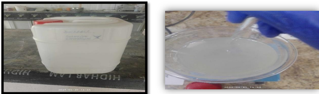
Figure II. 7: Solution de silicate de sodium utilisée dans le béton auto-cicatrisant.
