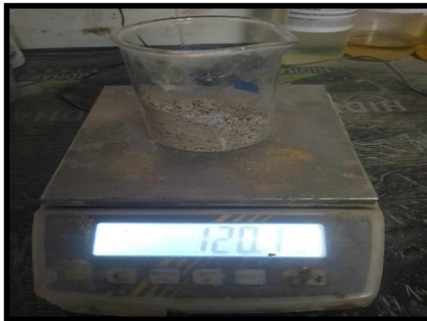
Figure II. 26: Illustration du pesage de l'échantillon.
