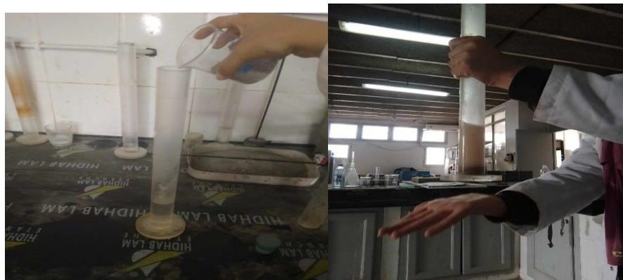
Figure II. 28: Introduction du sable dans la solution lavante.
