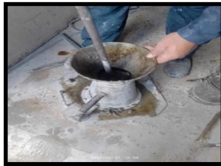
Figure II. 44: Remplissage du cône d'Abrams avec les différentes formulations de béton après malaxage
