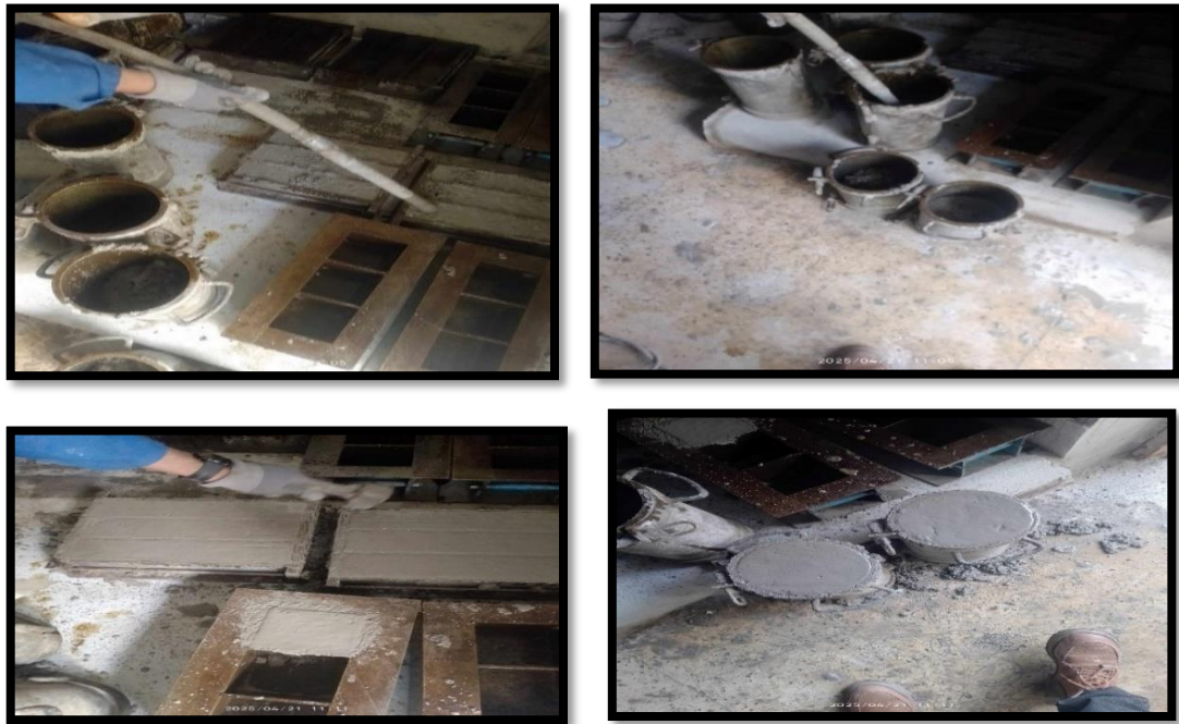
Figure II. 47: Uniformiser la surface des éprouvettes à l'aide d'une spatule afin d'assurer une finition parfaitement lisse.
