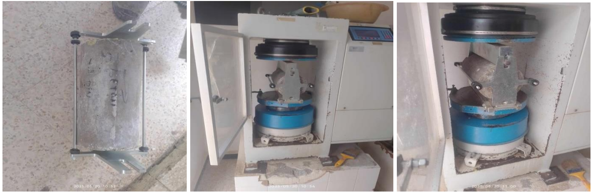
Figure II. 51: Dispositif utilisé pour l'essai de traction par fendage.
