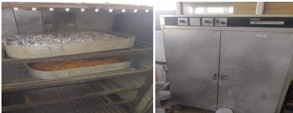
Figure II. 10: Matériaux placés dans l'étuve pour séchage.
