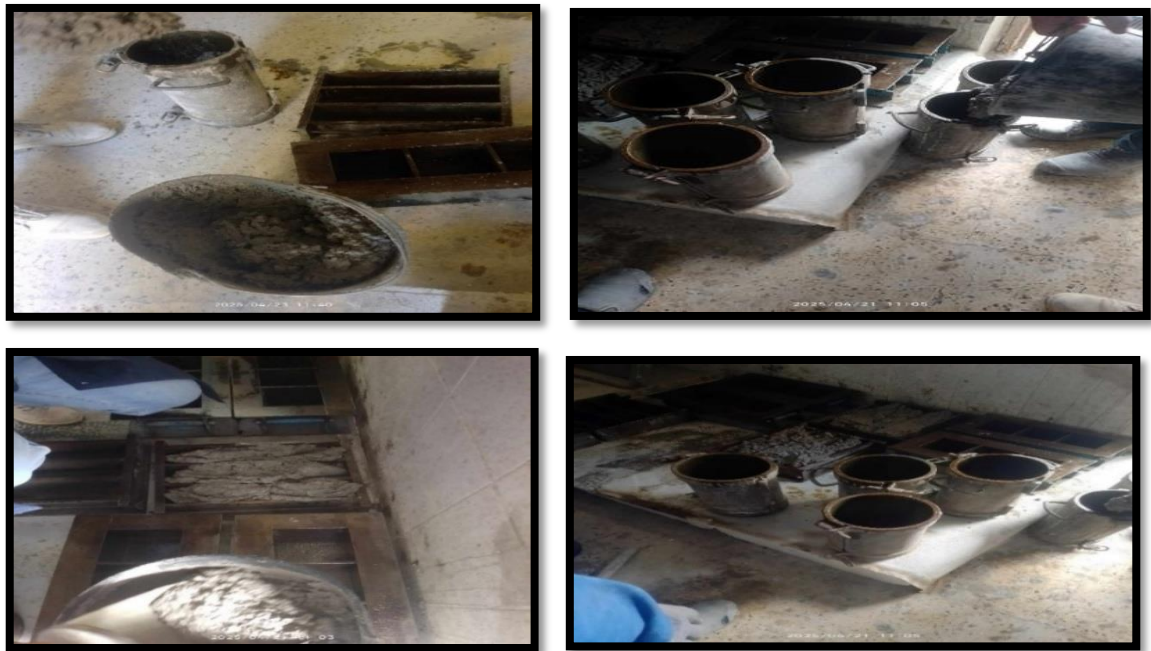
Figure II. 46: Remplissage des éprouvettes avec les différentes formulations de béton après malaxage
