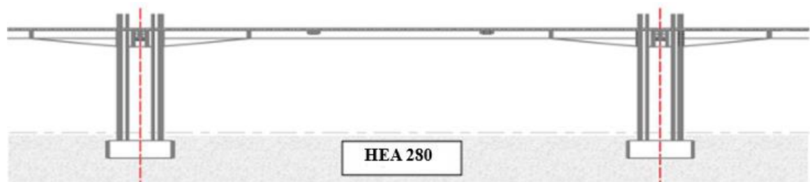
Poutre principale de 8,6 m
