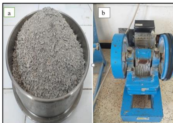
Figure II. 4: a) Sable recyclé, b) concasseur.
