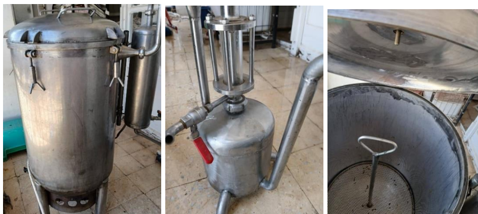
Figure 11. Dispositif d'extraction par hydro distillation (originale, 2025)
