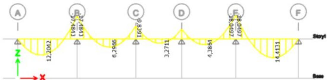
Figure III.9 : Diagramme des moments fléchissant à l'ELU
