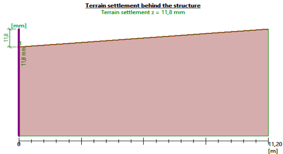
Figure IV.21 : Tassement du terrain derrière la structure pendant l'excavation de 6.5m.
