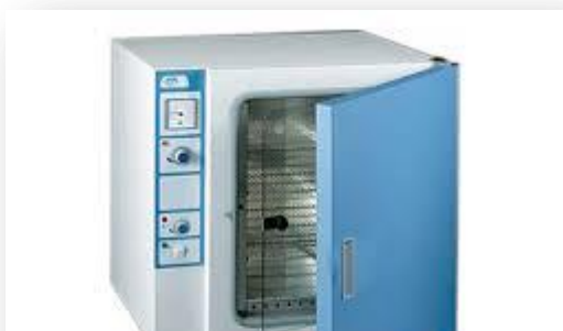
Figure 19 : Etuve de stérilisation (Original 2025)
