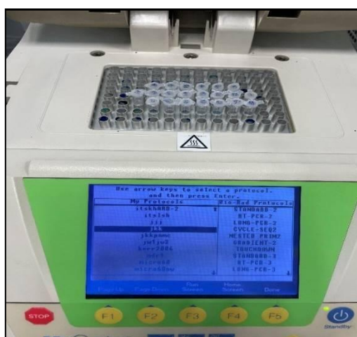
Figure 12 : Démarrage du programme d'amplification sur le thermocycleur
