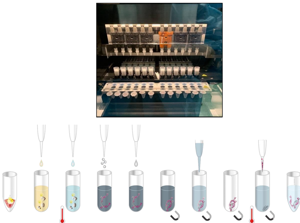
Figure 9 : Les étapes de l'extraction dans SaMag 12
