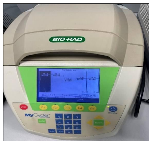
Figure 12 : Démarrage du programme d'amplification sur le thermocycleur
