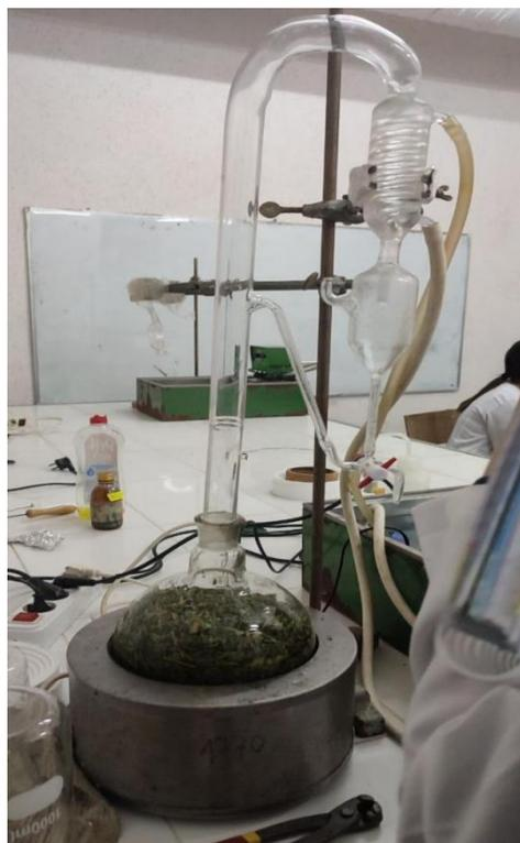
**Figure 4:**Montage d'hydrodistillation ( clevenger)
