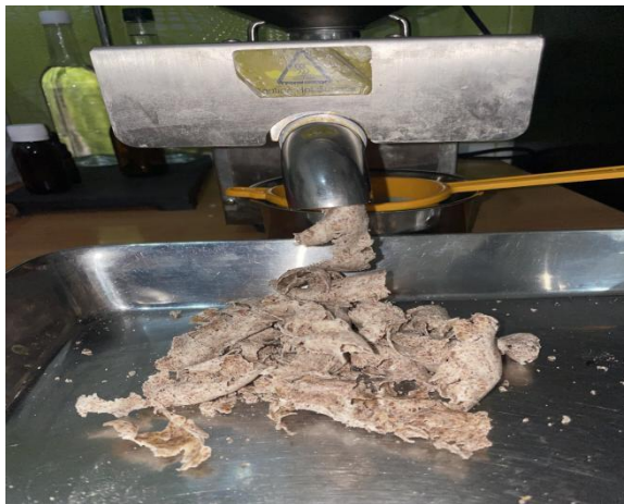
Figure 8 : (a) Mise des amandes dans la presse ; (b) Récupération de l'huile ; (c) Déchets solides (tourteaux) ; (d) Réintroduction des déchets pour extraire plus d'huile
