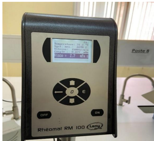
Figure 12 : Mesure de la viscosité dynamique à l'aide du viscosimètre
