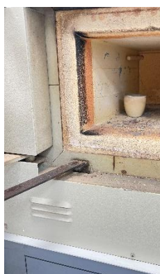
Figure 14 : Détermination des cendres par calcination et pesée gravimétrique
