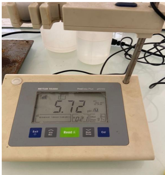
Figure 9 : Mesure du pH à l'aide d'un pH-mètre numérique
