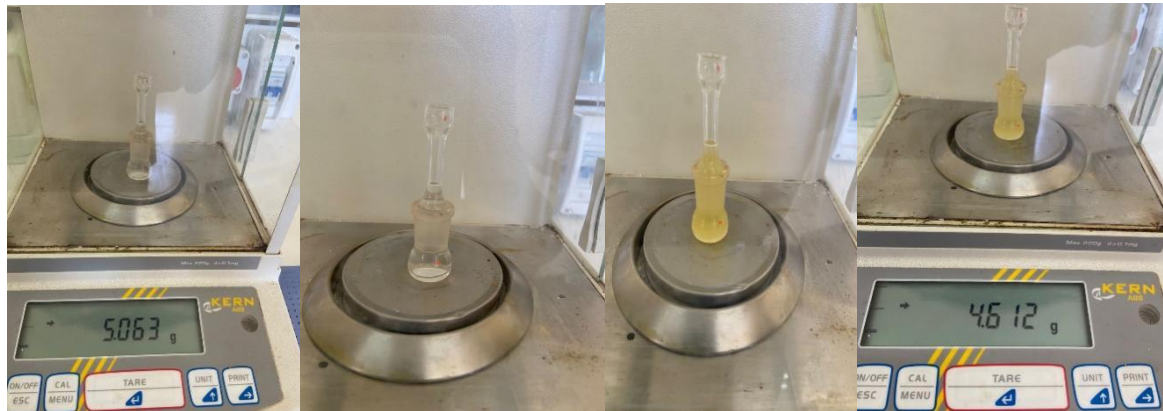
Figure 11 : Détermination de la densité de l'huile végétale par pycnométrie
